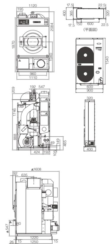
※図面の寸法は突出部分を含みます。
